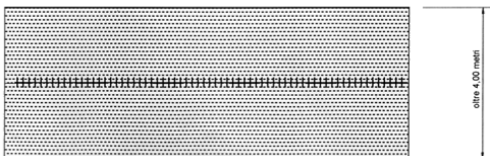
figura 14 scavo al centro della strada
